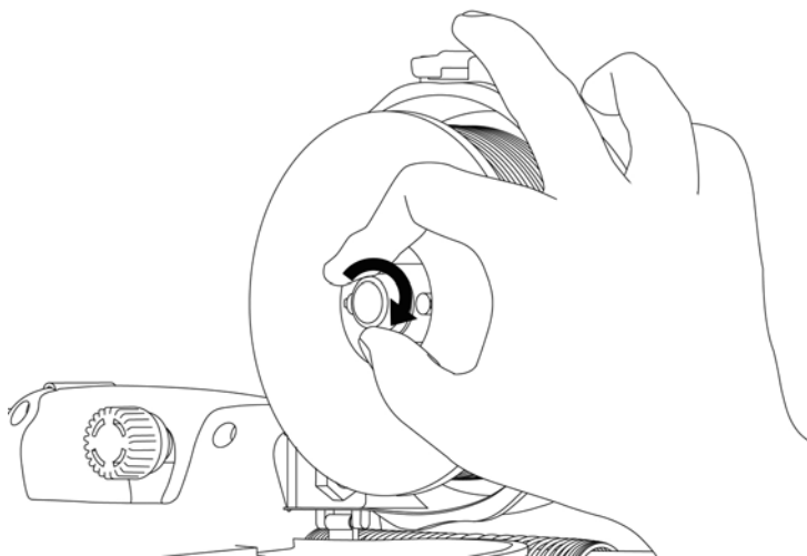
Рис. 7.6. Фиксация катушки с проволокой.
