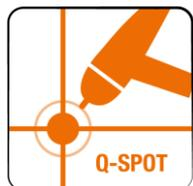
Режим точечной сварки позволяет точно расположить электрод в точке соединения. Только после подъема электрода аппарат производит импульсную сварку в течение оговоренного времени.
