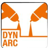
Функция, которая при изменении длины дуги, сохраняет размер сварочной ванны, что позволяет избежать перегрев детали, пластических деформаций и потери механических свойств. Это реализуемо за счет автоматической регулировки напряжения дуги и силы тока.
