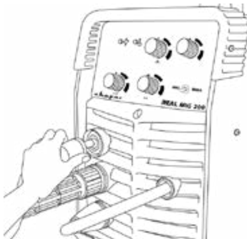
Рис. 7.2. Подключение силового наконечника клеммы заземления.
